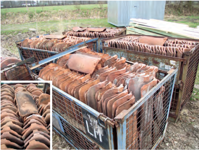
Abb. 2a–c: Die vereinbarte Beschaffenheit von 100 Jahre alten Ton-Dachpfannen kann nur die Beschaffenheit von 100 Jahre alten Tonpfannen sein (optischer Mangel?), die beschädigten Dachpfannen werden aussortiert, der Rest wird verlegt
